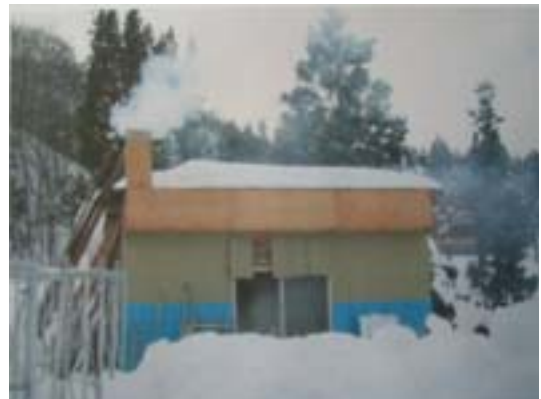
図-12 垂木ダクト煙突の作動実験 (屋根積雪50cm)
