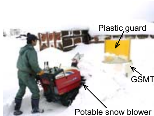
写真 4 2 回目以降の投雪方法 (除雪機による投雪)
