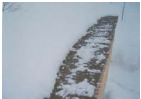
図-14 垂木ダクト煙突の作動実験 2/11/16:00 経過 4:00h
