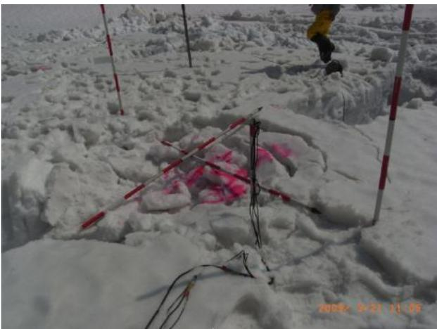
図 6 発破後の爆風圧センサと積雪表面クラック
