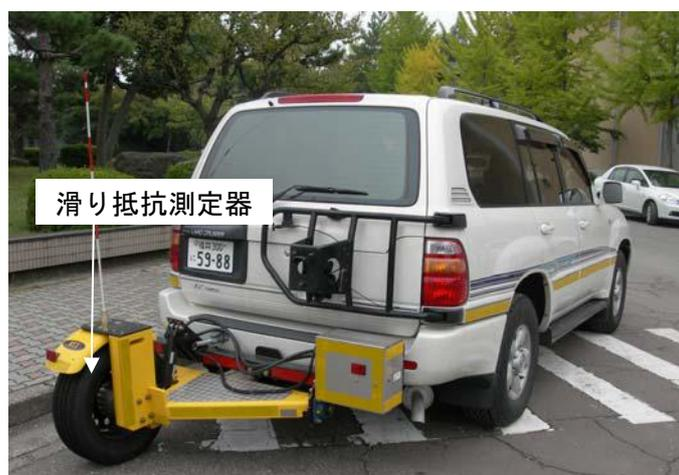
図1 連続路面滑り抵抗測定車
