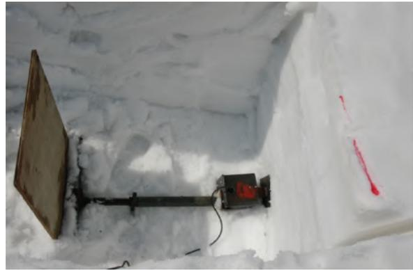
図 12 爆雪圧の計測状況
