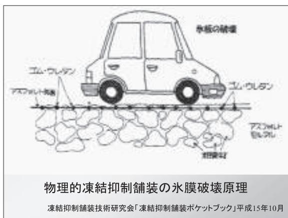
物理的凍結抑制舗装の水膜破壊原理
