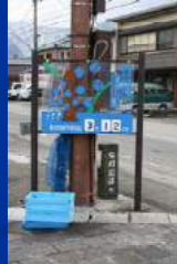
地下水位揭示板 (大野市)
