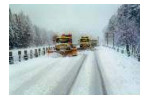
除雪作業(梯団除雪)
