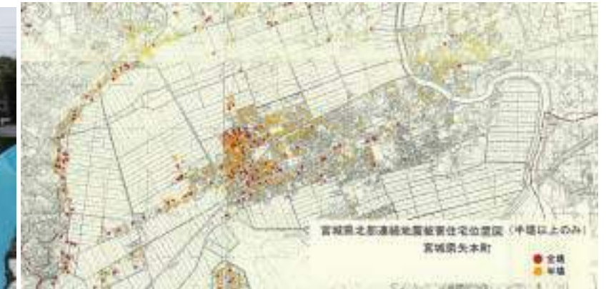
地震で被害を受けた家屋位置図(H15年宮城県北部地震)
