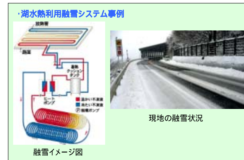
図56 温泉熱を利用した消融雪施設(鳥取県)
